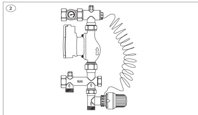
**(DK)** Fremløbsventilen kan monteres i vandret position, se tegning. Genbrug slutmuffen på den lodrette 3/4" tilslutning.
