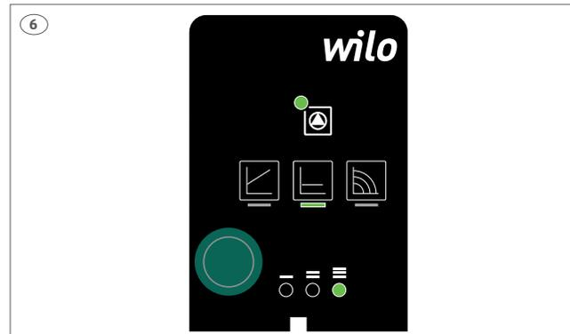
**(DK)** Fejl, som kan hindre pumpens drift (fx blokering), vises ved, at LED lyser rødt. Hvis der vises en fejl, ret fejlen, og afvent automatisk genstart af pumpen.
